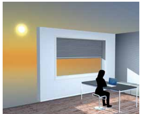
Frühling/Herbst: Für optimale Lichtverhältnisse am Arbeitsplatz werden Rollläden abhängig vom tieferen Sonnenstand weiter gesenkt.
